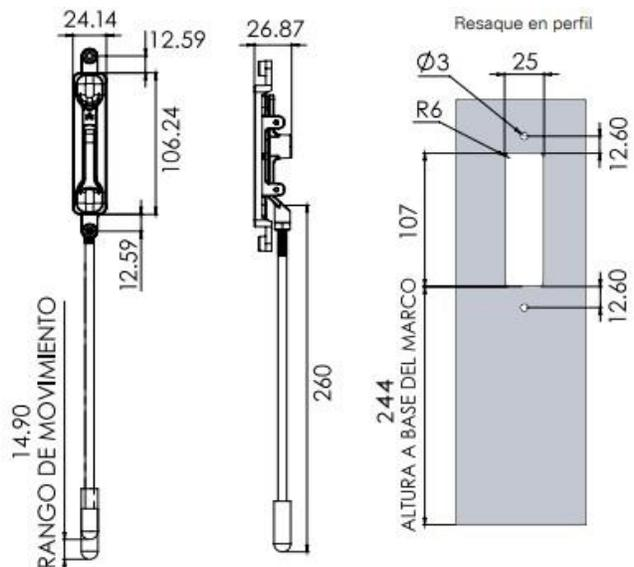
Operador brazo largo de 9" derecho e izquierdo, para ventana de proyección. Compatible con manivela 1141 y mariposa 2241. \*Incluye guía de acero inoxidable y tornillería para instalación.
